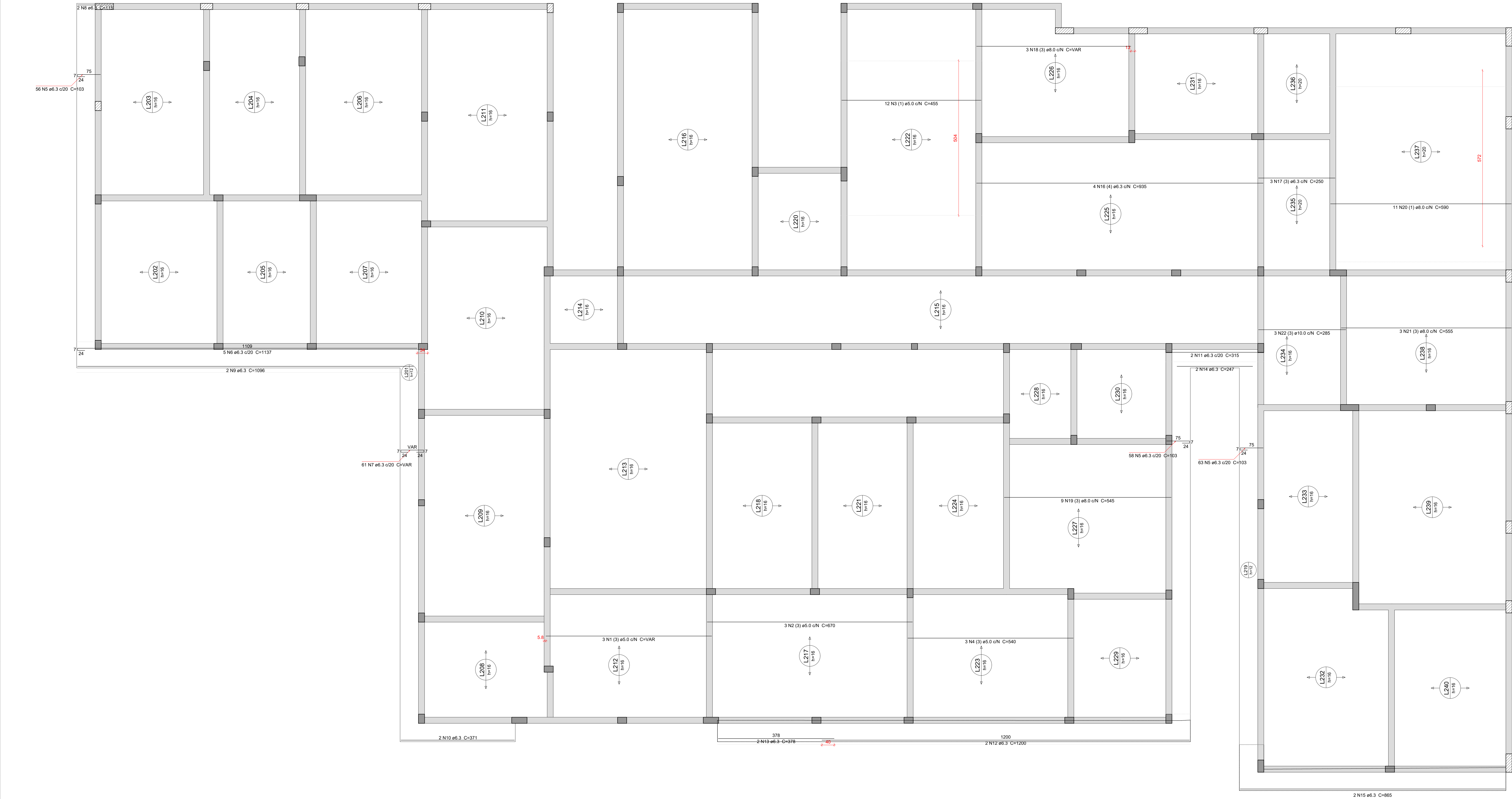
Armação positiva das lajes do pavimento COBERTURA 1 (Eixo Y)
